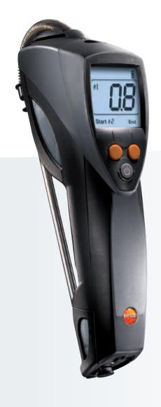
L'appareil de mesure testo 308 est conçu pour déterminer rapidement l'indice de suie. Il détermine au dixième l'indice avec un contrôle automatique du débit. L'écran LED fortement éclairé autorise un emploi dans les endroits même les plus sombres. Son accumulateur est compatible avec celui des analyseurs testo 327 et 330. Son utilisation simplifiée au maximum et sa forme ergonomique le rendent accessible à tous.
